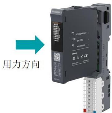
① 功能模块对准标准基座按照图示方向适当用力。
