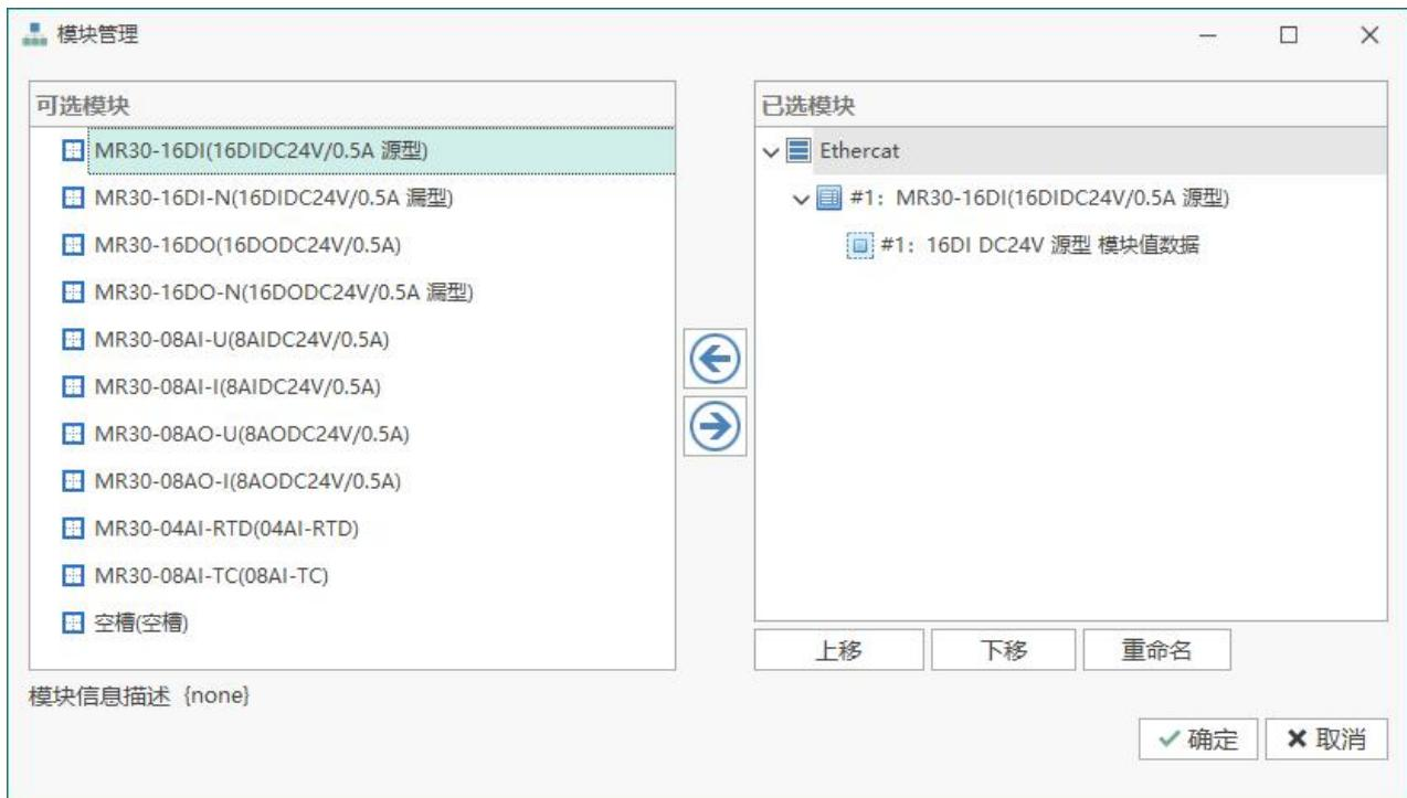
点击对应的可选模块在左下角会显示选中 IO 模块的信息，双击或则使用选择组态按钮后，会在右侧下方显示已经组态的模块数量，当已选模块数量为“31”时字体会显示为红色字体，此时无法继续选择模块。
